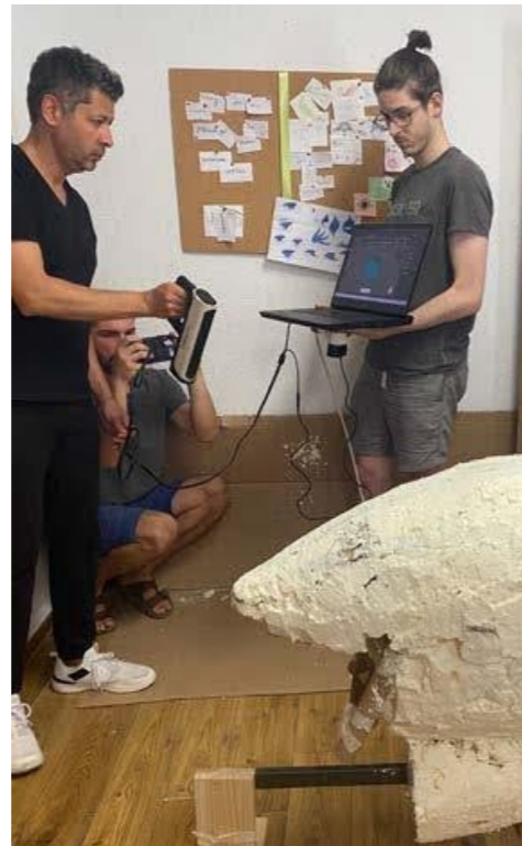
Fig 3: Giovanni Viteri usa el escáner de luz estructurada junto con estudiantes para tomar información de una maqueta de volumen.
